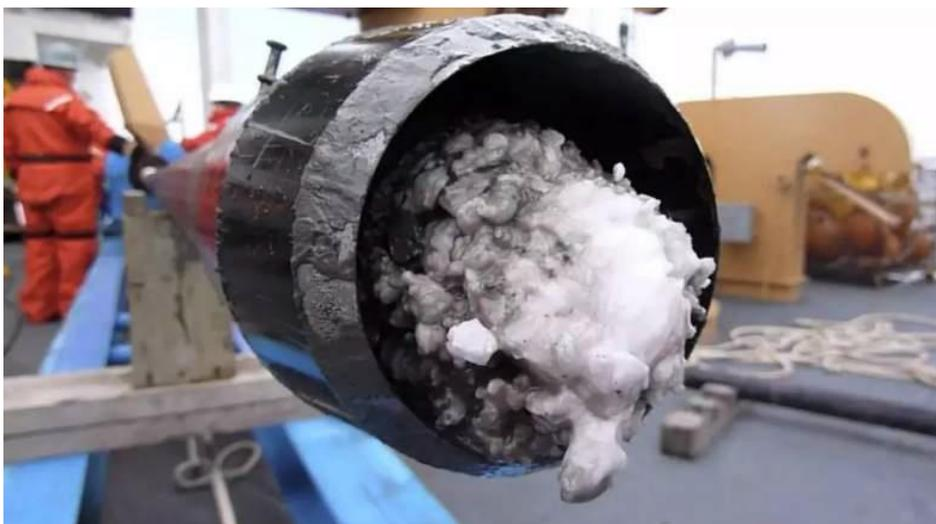
Figura 1.3: Hidrato de gás formado em uma tubulação durante a operação. Retirado de Jozian e Vafajoo [15].
