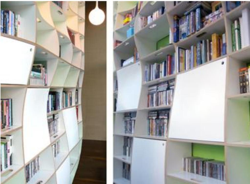
Figura 19: Estante em MDF cortada em máquina CNC vai de piso a teto. A fabricação digital permite a produção de formas complexas. Fonte: <http://www.associatedfabrication.com>
