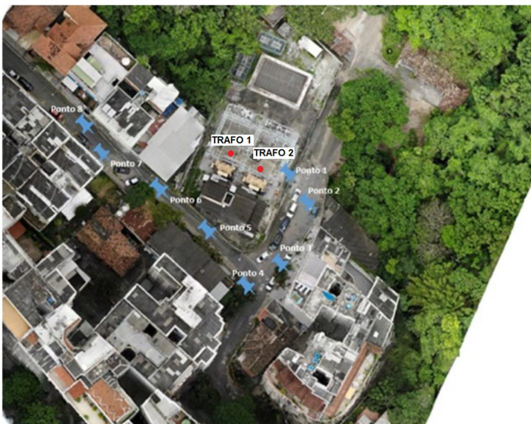
Figura 1.1: Definição dos pontos de monitoramento da medição da pressão sonora. Na figura, as denominações TRAFO 1 e TRAFO 2 indicam a posição dos dois transformadores de alta tensão em operação.
