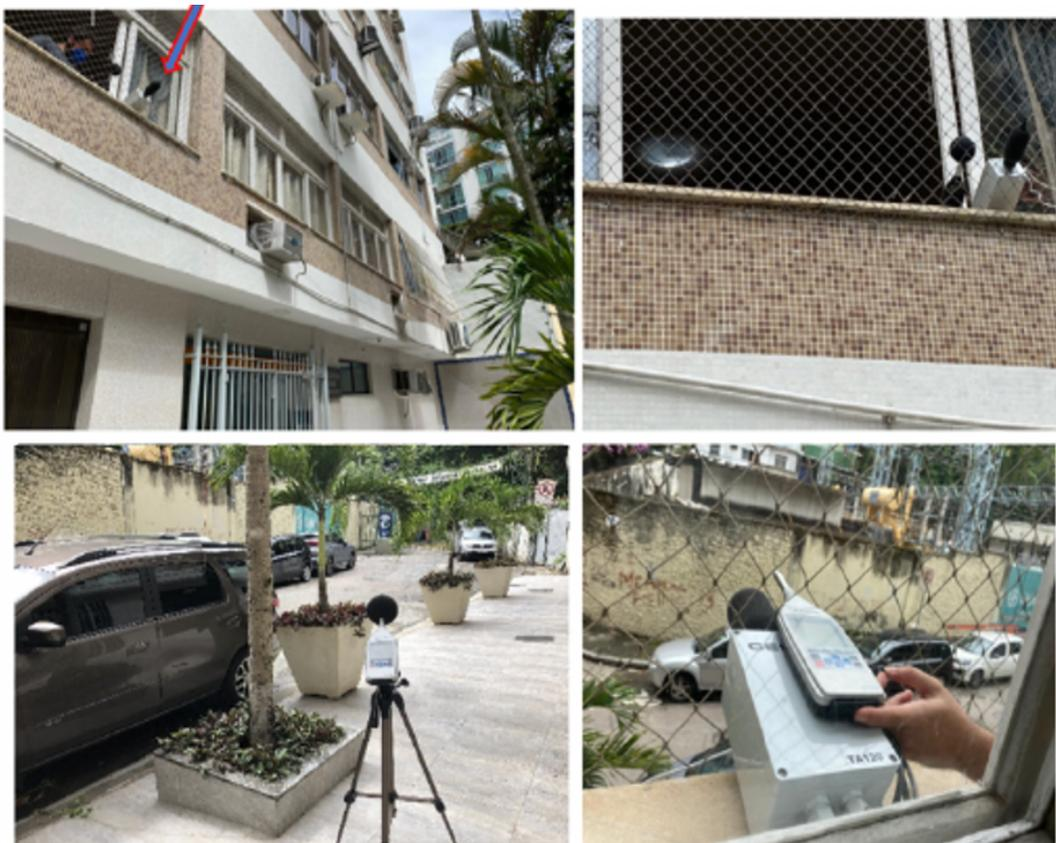
Figura 1.2: Posicionamento da estação remota de vigilância acústica.
