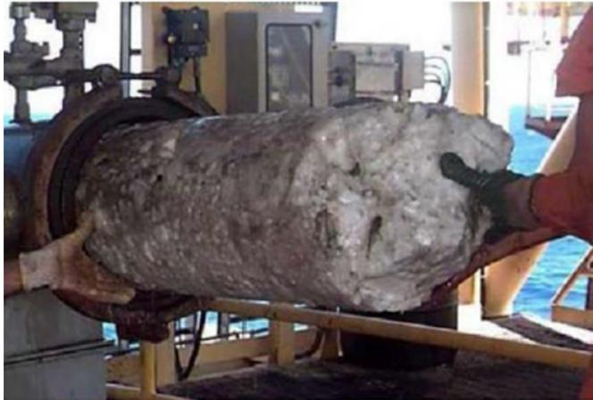
Figura 2.4: Plugue de hidrato sendo removido de dentro de uma tubulação. [7]
