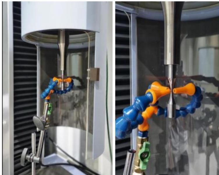
Figura 14 – Montagem do corpo de prova no equipamento Shimadzu [8]
