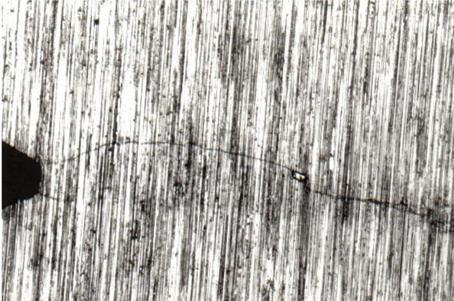
Figura 1 – Esquema de nucleação a partir de um concentrador de tensão (Imagem cedida pelo orientador)
