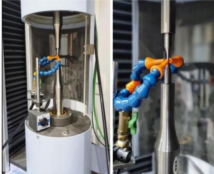
Figura 16 – Montagem de ensaios com tensão média [8]
