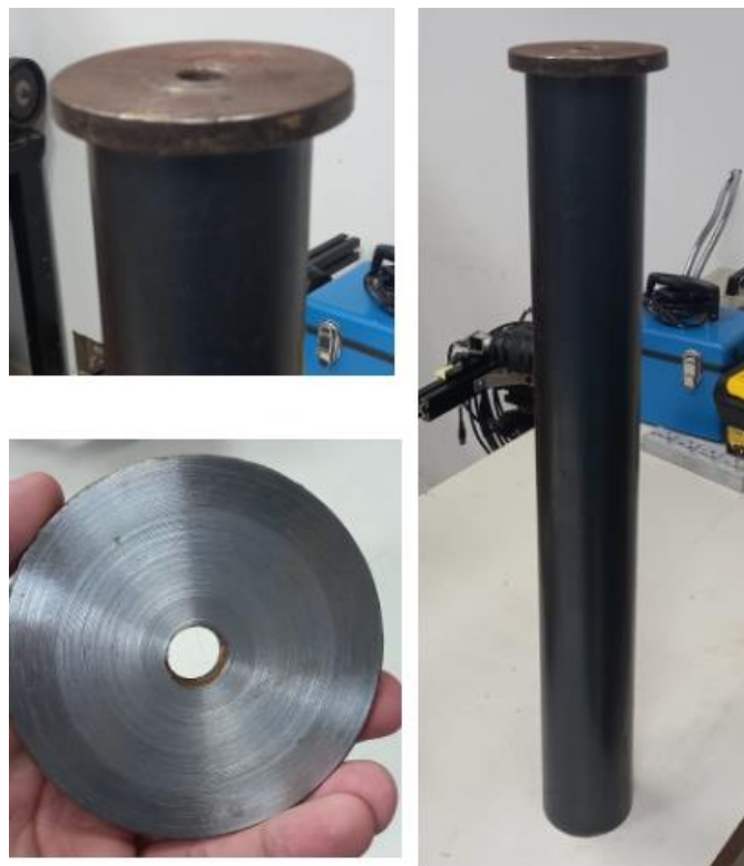
Figura 10: Tubo e tampo utilizados como base, antes de serem soldados. (Fonte: Elaborada pelo autor, 2024).
