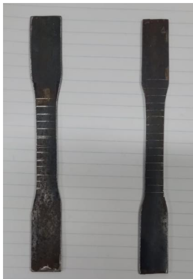
Figura 14: Corpos de prova utilizados no ensaio de tração. (Fonte: Elaborada pelo autor, 2024).
