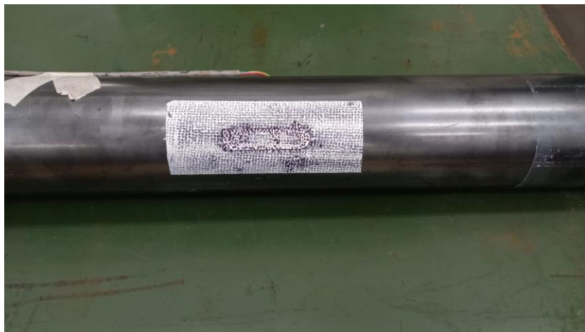
Figura 12: Padrão de pontos aplicado no vaso de pressão. (Fonte: Elaborada pelo autor, 2024).
