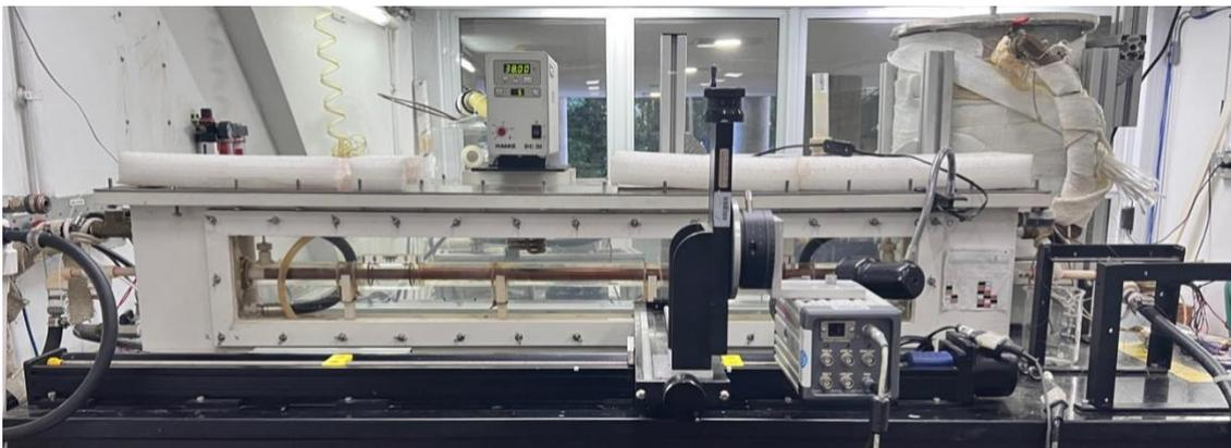
Figura 3: Bancada Experimental para o estudo do processo de remoção de parafina realizado no LEF PUC-Rio.
