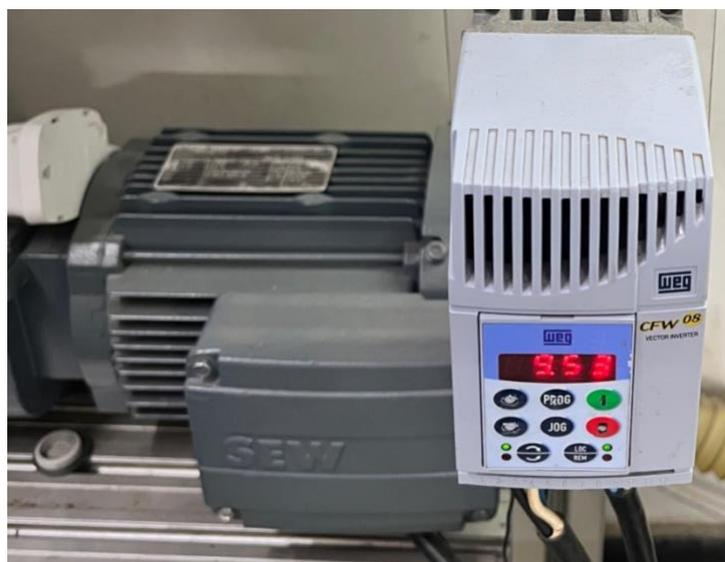
Figura 13: Inversor de frequência da WEG e ao fundo a bomba volumétrica Netzsch.
