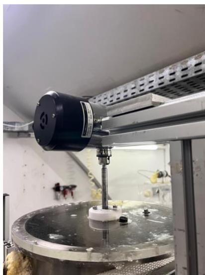
Figura 9: Misturador do reservatório da mistura de trabalho.
