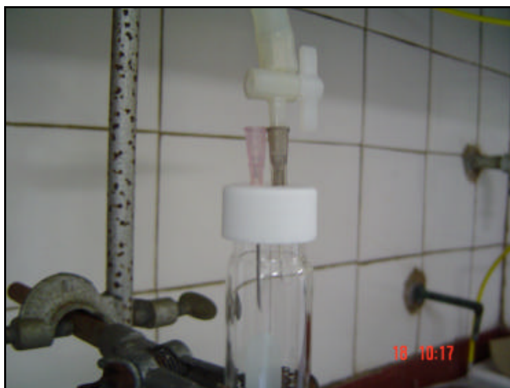
Figura 5.7. Agulhas de entrada de nitrogênio e de saída de ar.
