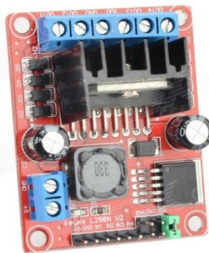
Figura 25: Ilustração de uma Ponte H extraído de [10]
