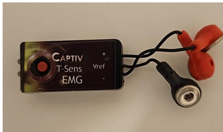
Figura 36: Novo sensor EMG T-Sens Captiv (captura própria)
