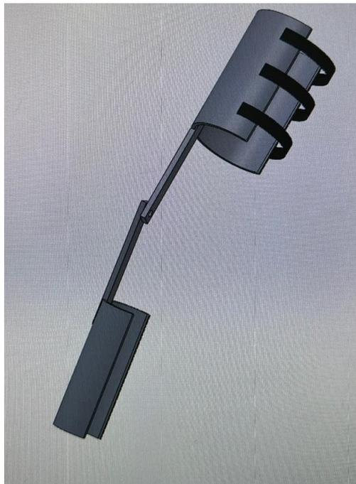
Figura 39: Ilustração do desenho da órtese feita no SolidWorks (captura própria)
