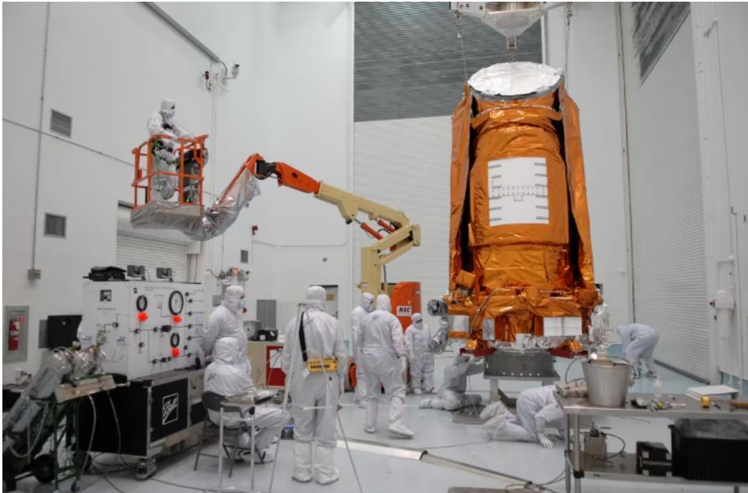
Figura 4: Dentro da Instalação de Processamento de Riscos da Astrotech em Titusville, Flórida, antes de seu lançamento, a espaçonave Kepler da NASA™ é colocada em um suporte para abastecimento [4].
