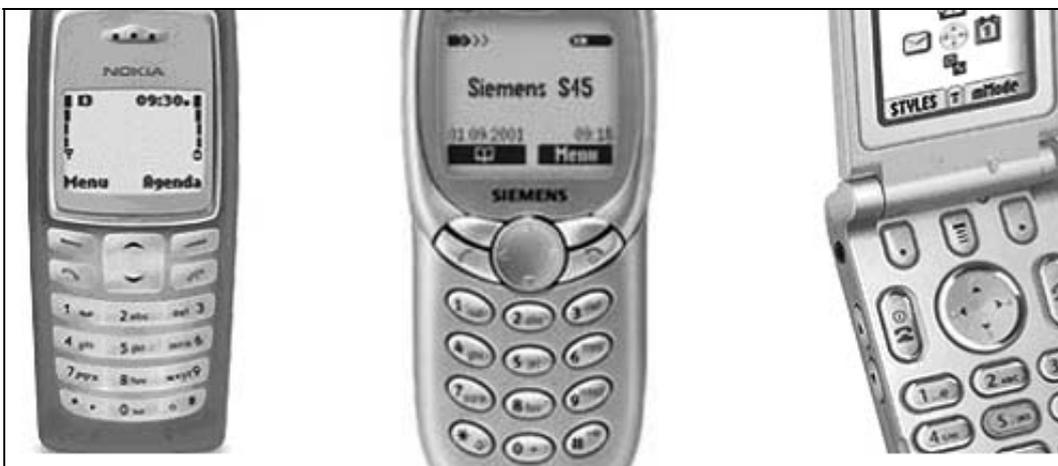
Figura 6 – Exemplos do uso de *softkeys* em aparelhos
