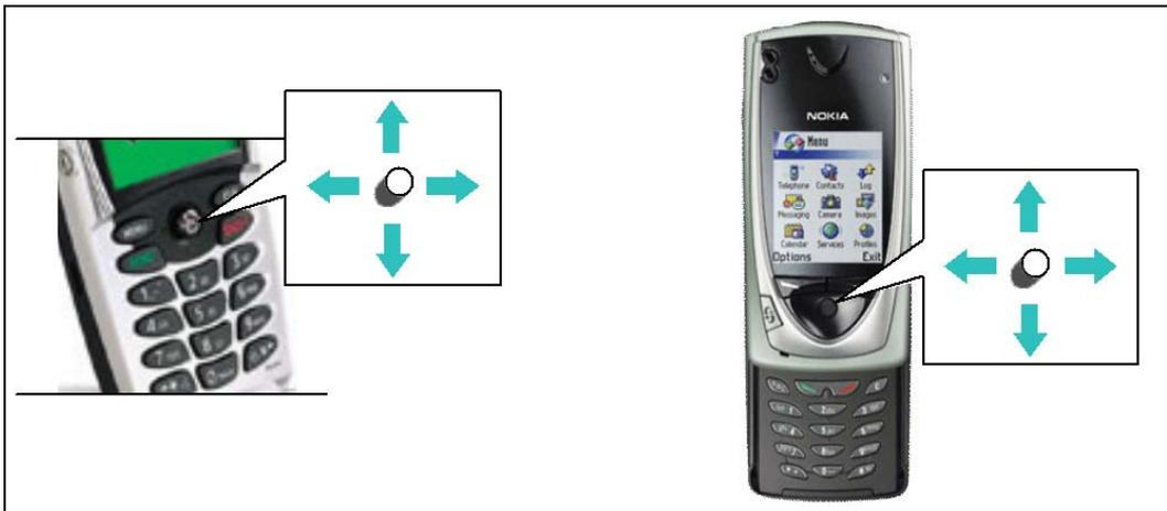
Figura 11 – Exemplos de aplicação de teclas tipo *joystick*
