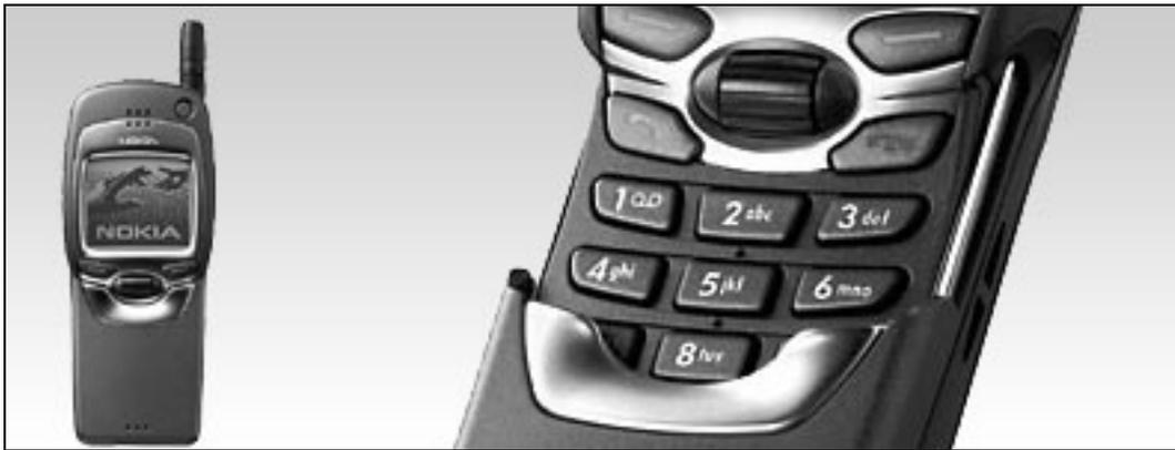
Figura 12 – Nokia 7110, um dos primeiros aparelhos no formato *slider*, e o primeiro a adotar tecla de rolagem para acesso aos dados
