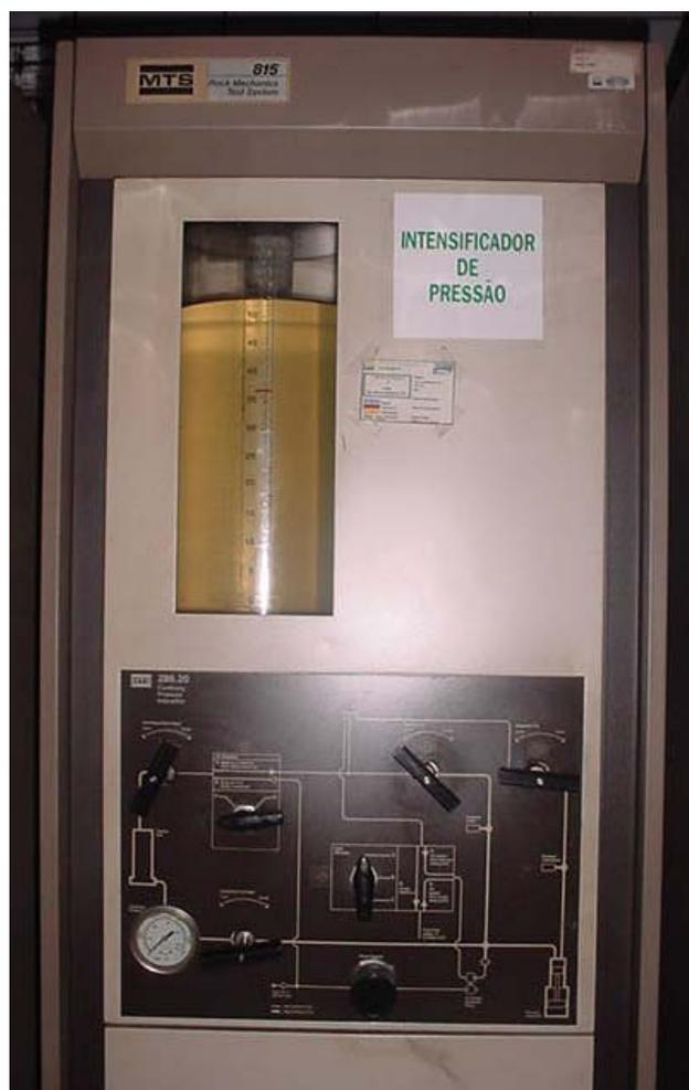
**Figura 3.11** – Foto do intensificador de pressão hidráulico servo-controlado
