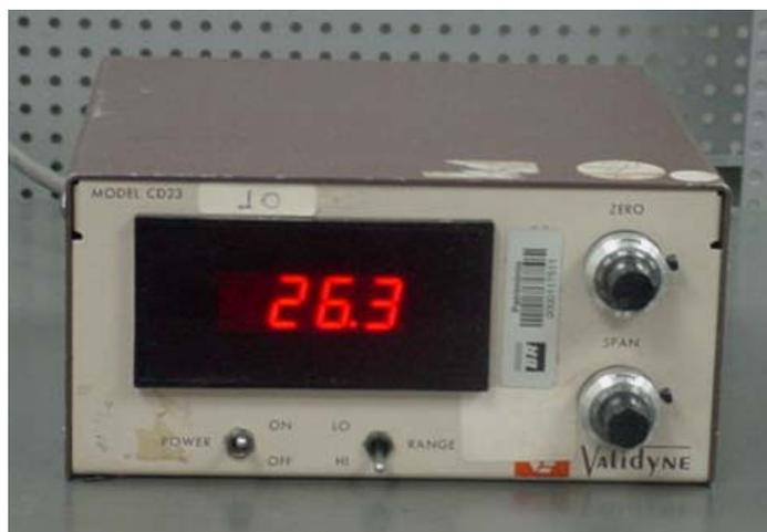
**Figura 3.14** – Foto da caixa de leitura de transdutor Validyne
