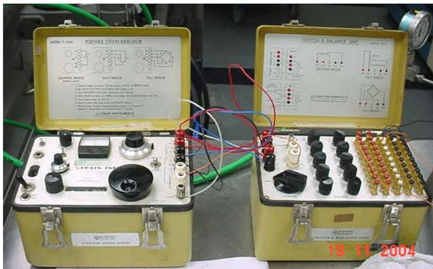
**Figura 3.8** – Foto do sistema de leitura de deformação de *strain gages*
