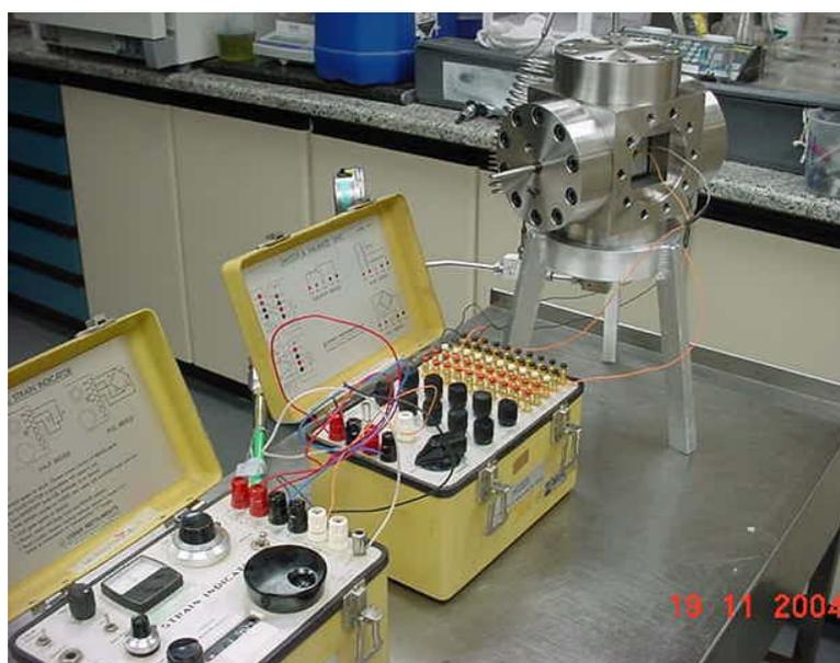
**Figura 3.10** – Foto da montagem dos ensaios de compressão biaxial, realizados para verificação da rigidez das membranas
