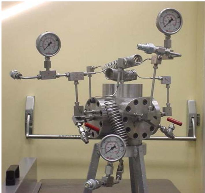
**Figura 3.5** – Foto da célula triaxial cúbica montada, com as três linhas espirais de tensão
