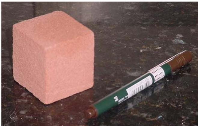
**Figura 3.18** - Foto de um corpo de prova do arenito Botucatu
