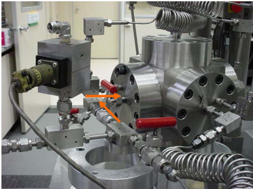
**Figura 3.19** – Foto indicando a trajetória percorrida pelo óleo de fluxo na direção X e na direção Y (com excessiva perda de carga)
