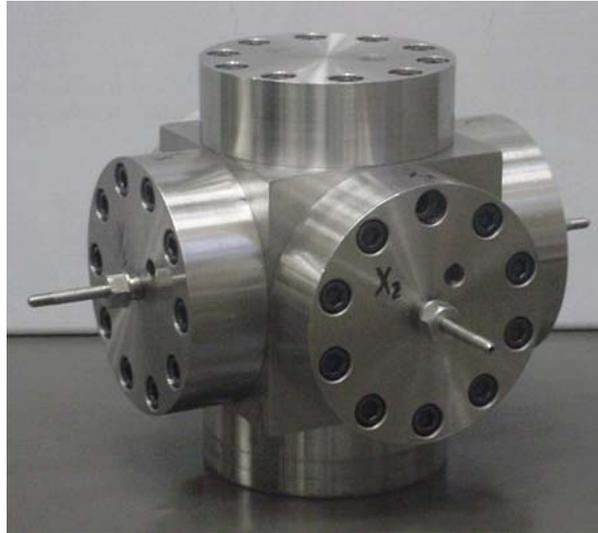
**Figura 3.1** – Foto do conjunto geral da célula triaxial cúbica, vista em perspectiva
