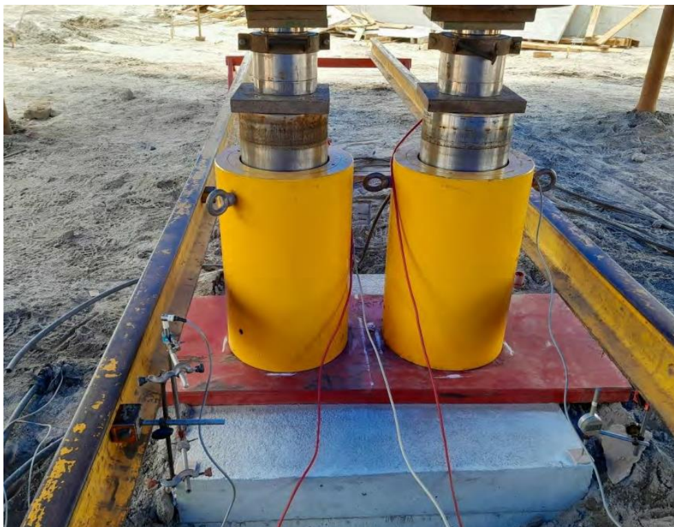
Figura 6.22 – Sistema de leitura dos recalques (modificado de EXE22202-PCE-REL-001-R00, Geoprova, 2023).
