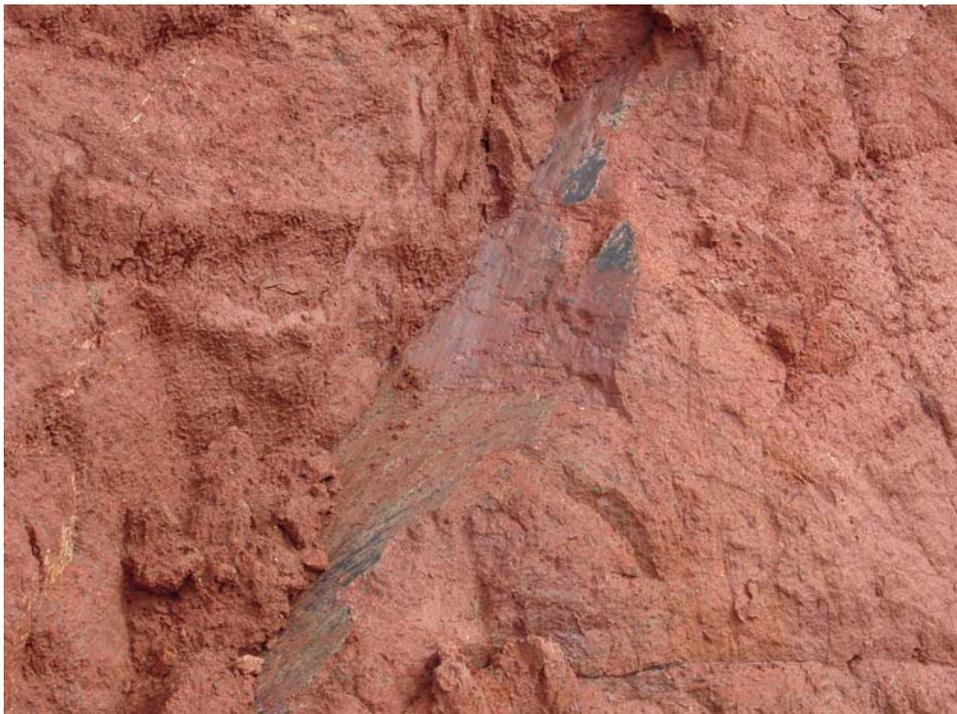
Figura 8 – Fratura inclinada apresentando estrias de fricção no talude de solo residual.
