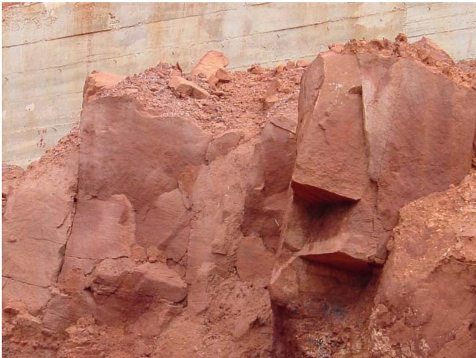
Figura 11- Arenito apresentando descontinuidades sub-horizontais e sub-verticais.
