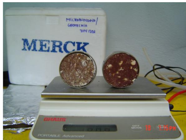
Figura 16 - Amostras de SR2 apresentando redução de volume após secagem.
