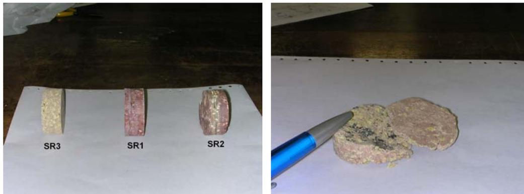
Figura 15 – Amostras com fraturas sub-horizontais dispostas aleatoriamente.
