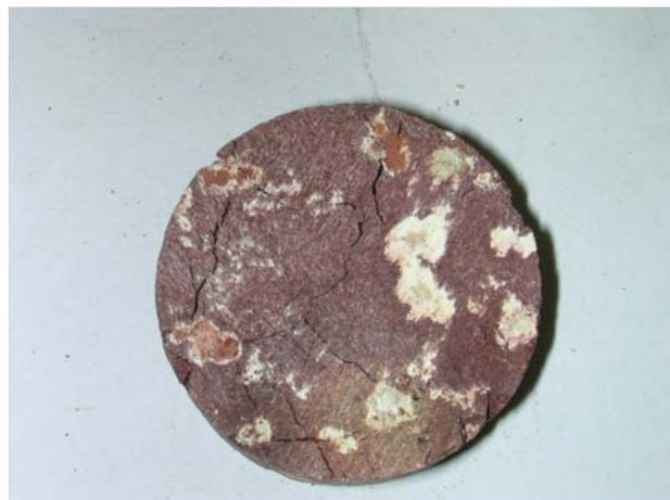
Figura 17 – SR2 apresentando trincas, após secagem ao ar.
