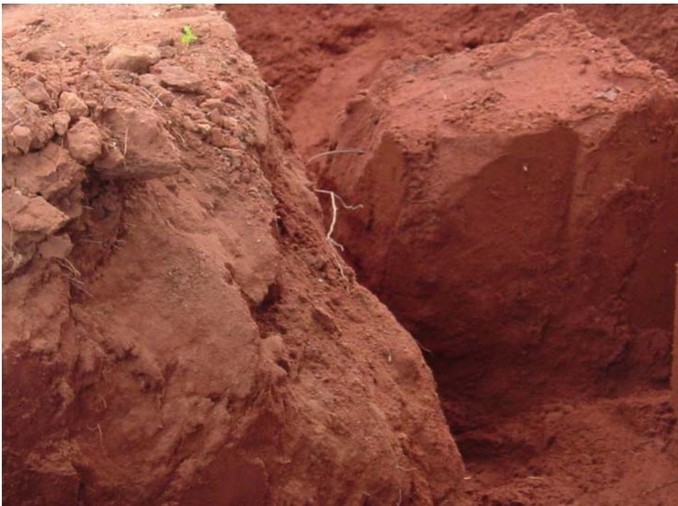
Figura 10– Solo coluvionar ou vestígio de capeamento antigo.
