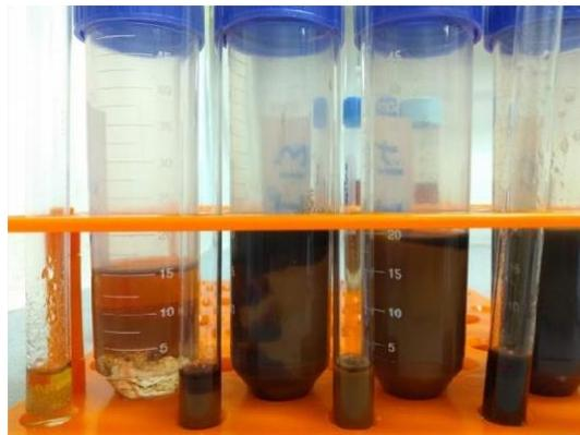
Figura 16. Emulsões modelos formadas pelas frações extraídas. Da esquerda para a direita: NA1, IM3, IM2, IM1.
