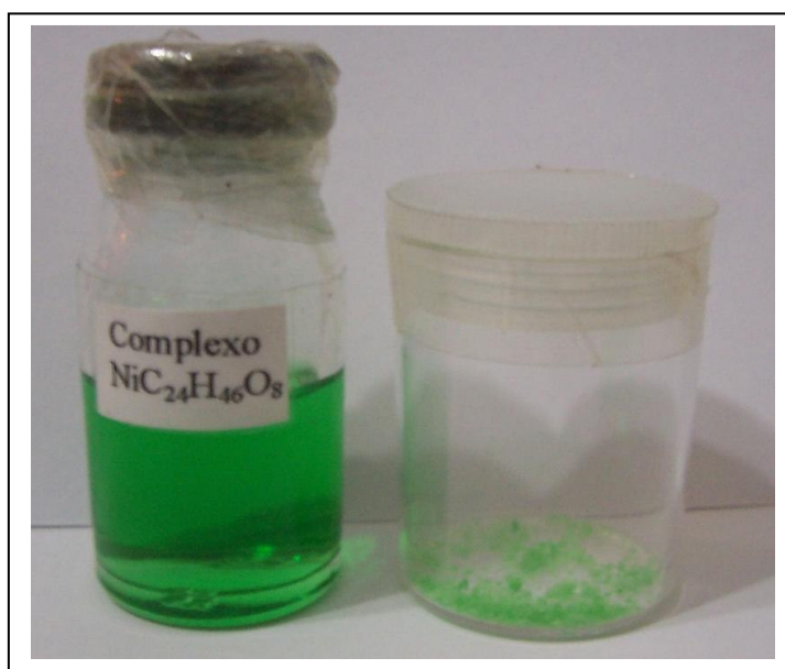
Figura 23 – Estruturas propostas para o complexo sólido de Ni (II) com ácido hexanóico; A – Solução verde e B – Cristais verdes.
