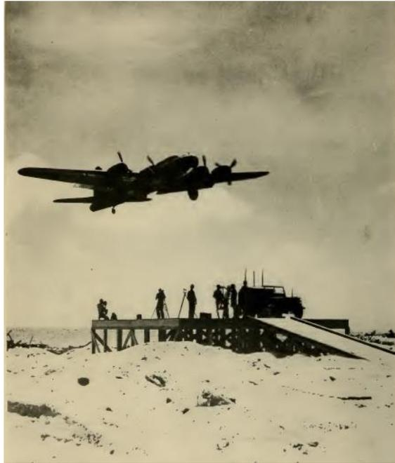
Figura 19: Drone B-17 aterrissando.
