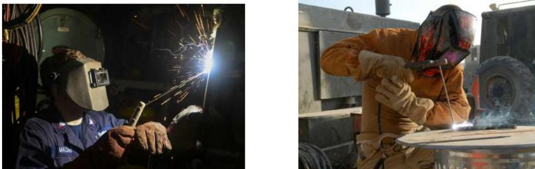
Figura 2.8: Máscaras de solda, de lente escura (esquerda) e de lente automática (direita).<sup>12</sup>
