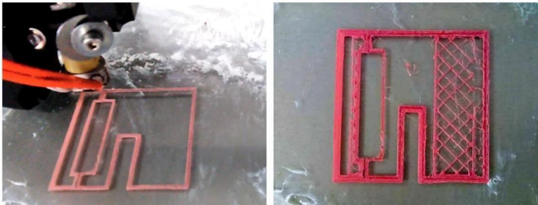
Figura 37 – Primeiro teste de impressão com filamento desenvolvido a partir de retalhos de poliamida.
