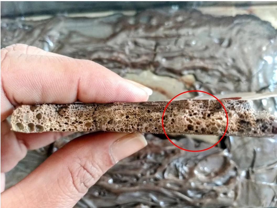
Figura 45 – Avaliação da parte central do material após o processo de fusão.
