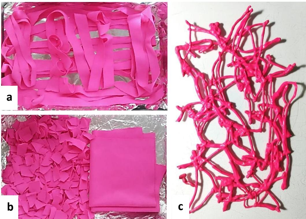
Figura 34 – Amostras do estágio 1. Disposição em diferentes formatos (a) e (b), e amostra depois do processo da fusão (c).
