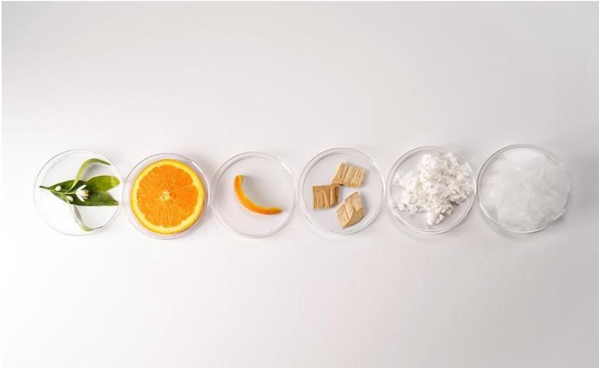
Figura 16 – Fibra celulósica à base de laranja e polpa de madeira. Fonte: <https://orangefiber.it>
