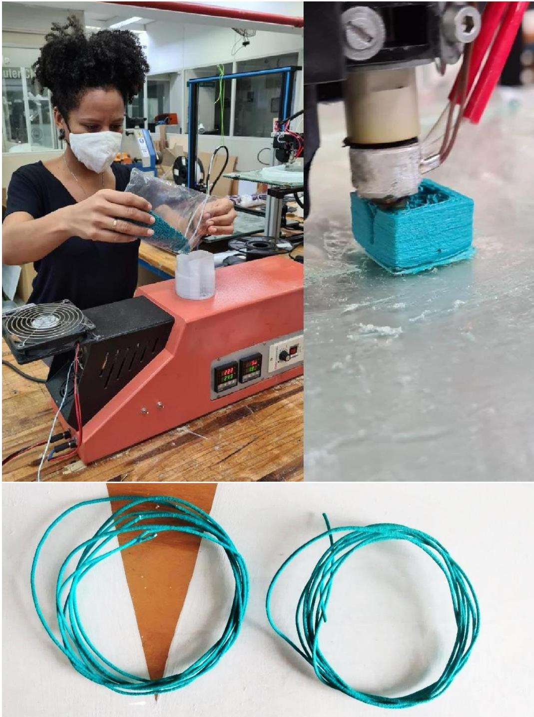
Figura 38 – Extrusão do filamento com 15% de poliamida virgem e teste de impressão.
