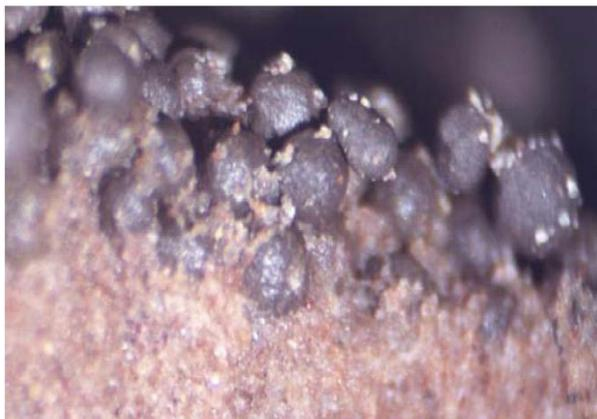
Figura 3.5 – Ilustração da penetração do propante na rocha da formação. (R.D. Barred. Et. Al. 2003).
