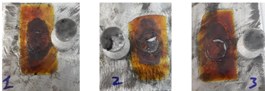
Figura 147. Corpos de prova depois de realizar o teste Pull Off, o corpo de prova 1 (poliimida PIR 003-cobre sem tratamento), o corpo de prova 2 e 3 (poliimida PIR 003-cobre com tratamento de Sn/Pd (0.1/0.2 g/l))
