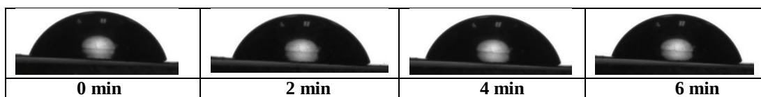
Figura 72. Gotas de glycerol na superfície da poliimida de fita kapton
