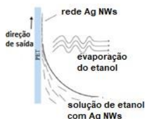
Figura 19. Diagrama de montagem de nanofios no processo de revestimento por imersão adaptado de Pu DF, et al., 2015.
