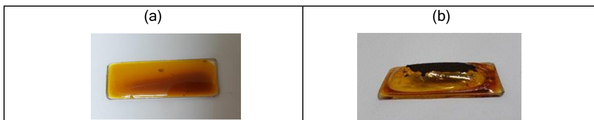
Figura 49. Defeitos por um esfriamento errado das membranas
