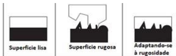
Figura 40. Problemas com área mínima de contato em caso de laminação de superfícies rugosas, adaptado de Friedrich, J., 2018.
