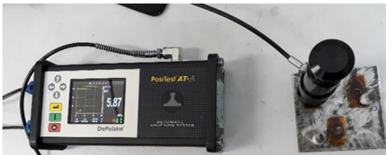
Figura 55. Testador de adesão Pull-Off para medir a adesão da poliimida com o cobre metálico
