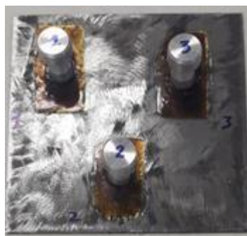
Figura 56. Dollys colados nos recobrimentos de poliimida-cobre (membranas funcionalizadas com Sn/Pd 0.1/0.2 g/l).
