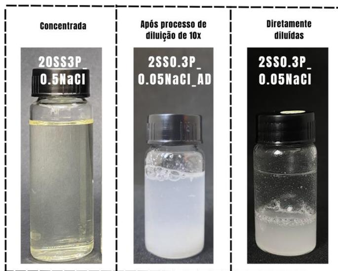
Figura 9 – Fotos de amostras, imediatamente após seu preparo, compostas por SS e PDADMAC na presença de NaCl no regime concentrado, após o processo de diluição e preparadas diretamente na concentração final.
