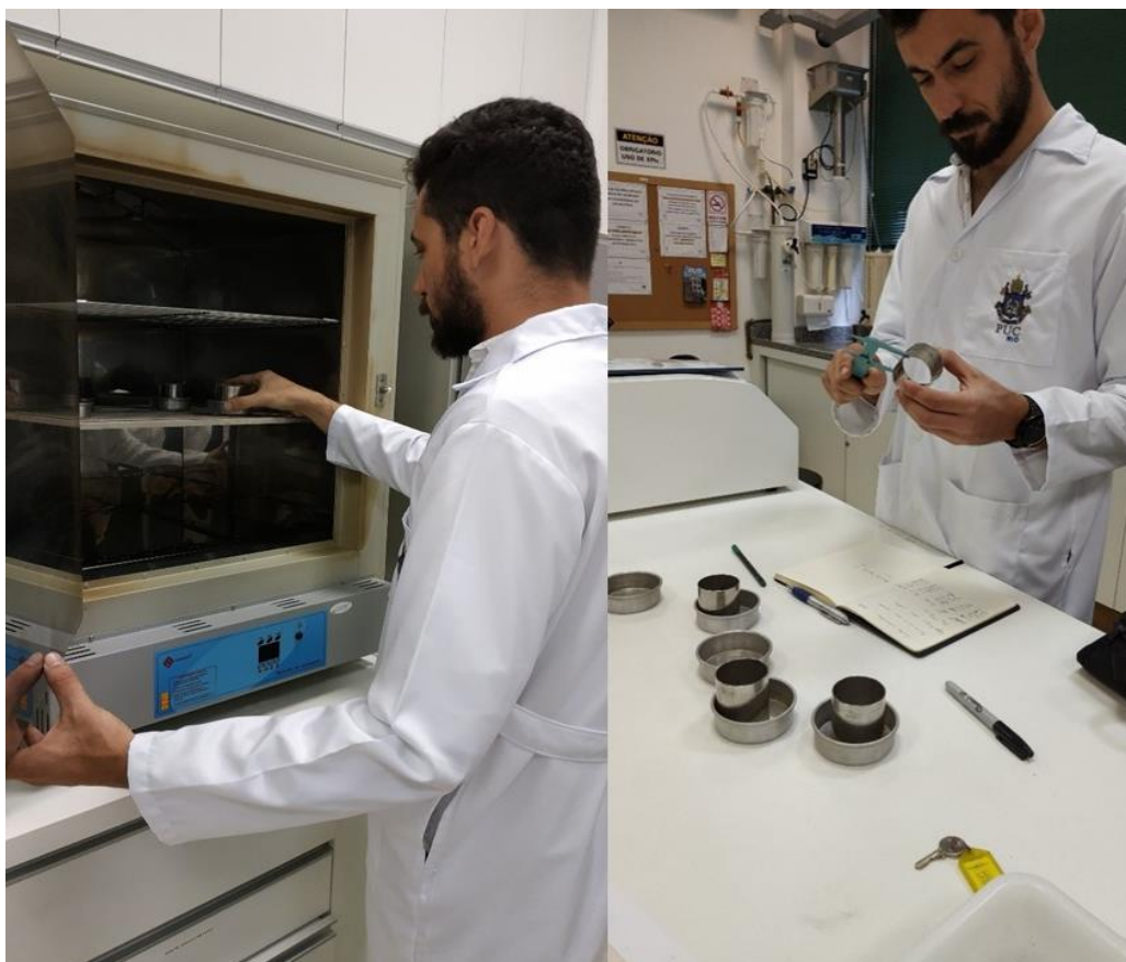
Figura 44 - Secagem das amostras em estufa e conferência dos volumes dos anéis de Kopecky utilizados em campo Fonte: Acervo pessoal.
