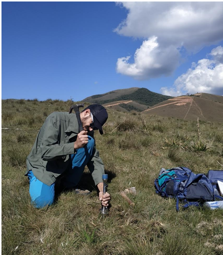
Figura 43 - Obtenção de amostras de solo com um amostrador de anel de Kopecky Fonte: Acervo pessoal
