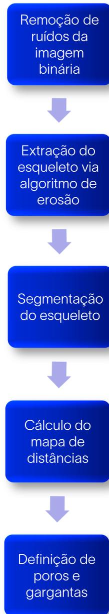
Figura 3.1: Fluxograma contendo as etapas envolvidas na construção da rede de poros e gargantas de uma imagem binária via esqueleto.
