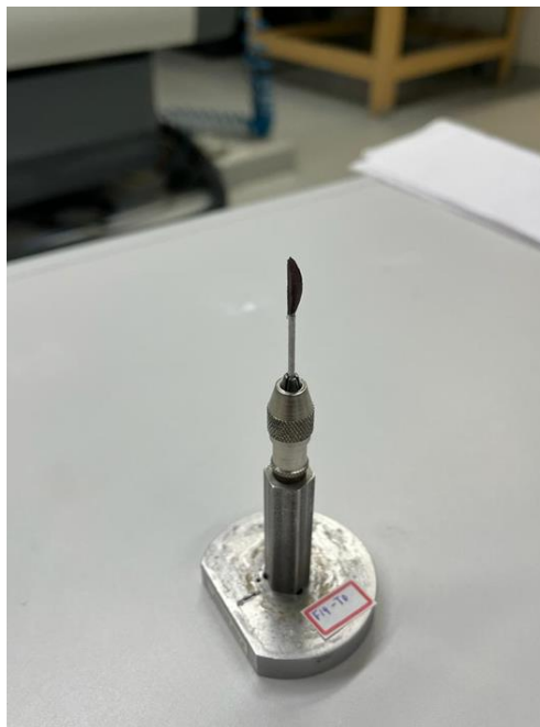
Figura 19 – Suporte com um fragmento de briquete pronto para ser tomografado.
