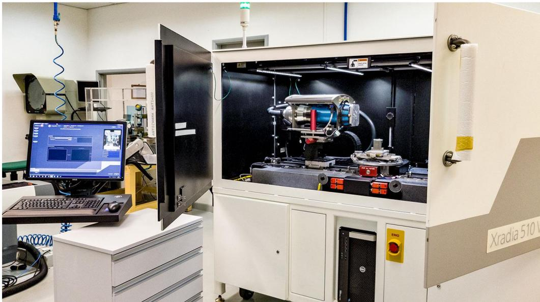
Figura 19: Equipamento da ZEISS, modelo Xradia 510 versa, utilizado para captura tomográfica das amostras de briquete.
