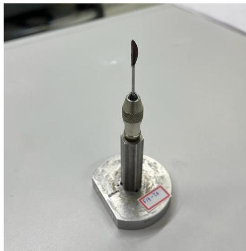
Figura 18: Uma amostra com a pequena barra fixada em seu maior eixo.
