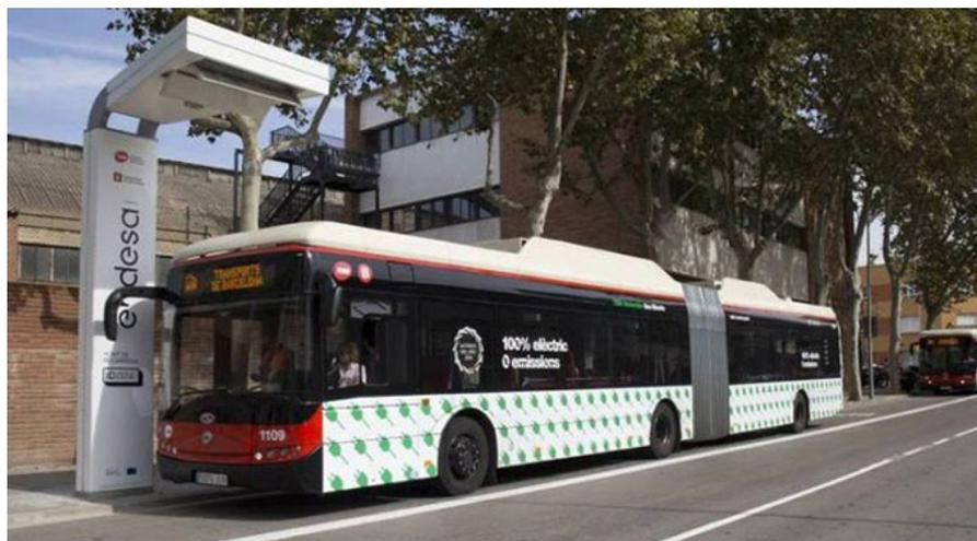
Figura 11 – Ônibus elétrico com recarga rápida em Barcelona.
