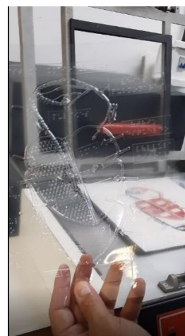
Figura 21 - Passo 6 impressão "Termoforming" Fonte: acervo da autora,2022
