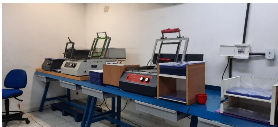
Figura 14 - Máquinas para impressão “Vacuum forming” ou “Thermoforming” Fonte: acervo da autora, 2022
