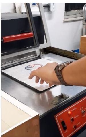
Figura 20 - Passo 5 impressão "Termoforming" Fonte: acervo da autora,2022
