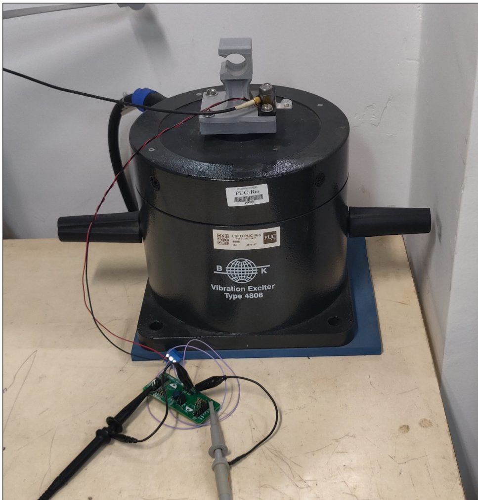
Figura 26 – Teste com agitador e filme PVDF
