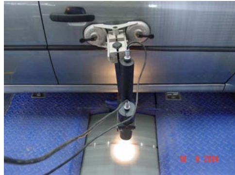
Detalhe da montagem do transdutor óptico para leitura da velocidade do rolo.
