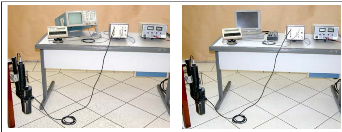
Figura 6.3: Configurações empregadas para determinação da forma do sinal emitido pelo transdutor.
