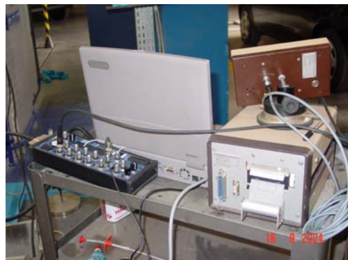
Montagem dos equipamentos, com detalhe da tela do software , mostrador de velocidade do CORREVIT® e parte traseira dos equipamentos.
