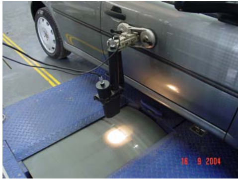
Detalhe da montagem do transdutor óptico para leitura da velocidade do rolo.
