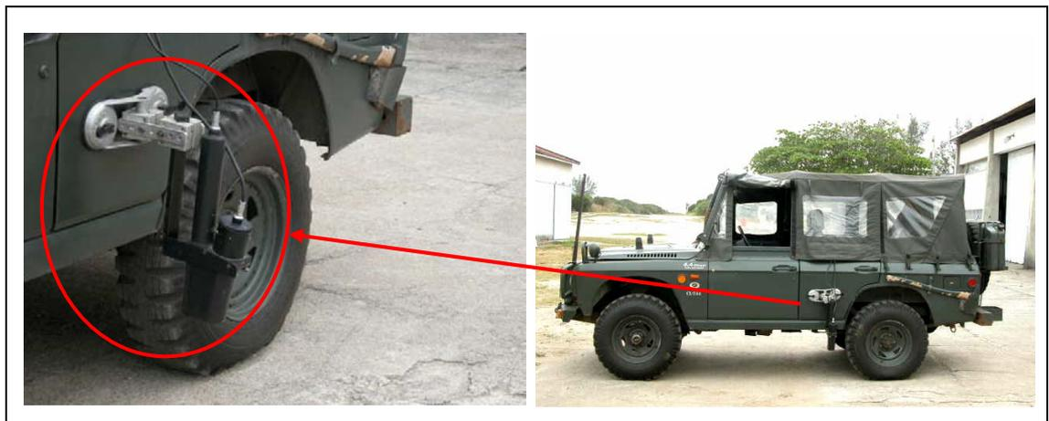
Figura 3.1: Instalação do Transdutor-L em um veículo.
