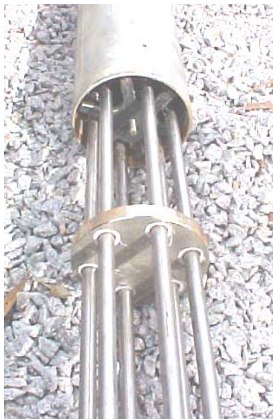
a) detalhe do disco espaçador
