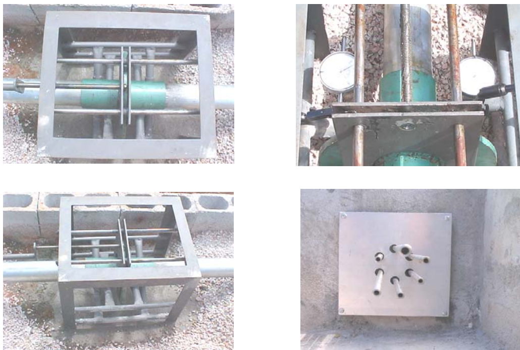
Figura 46 - Detalhes do dispositivo de movimentação das hastes e painel de leitura.
