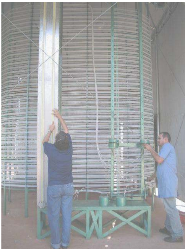
Figura 39 - Protótipo do Medidor Hidrostático de Recalques.
