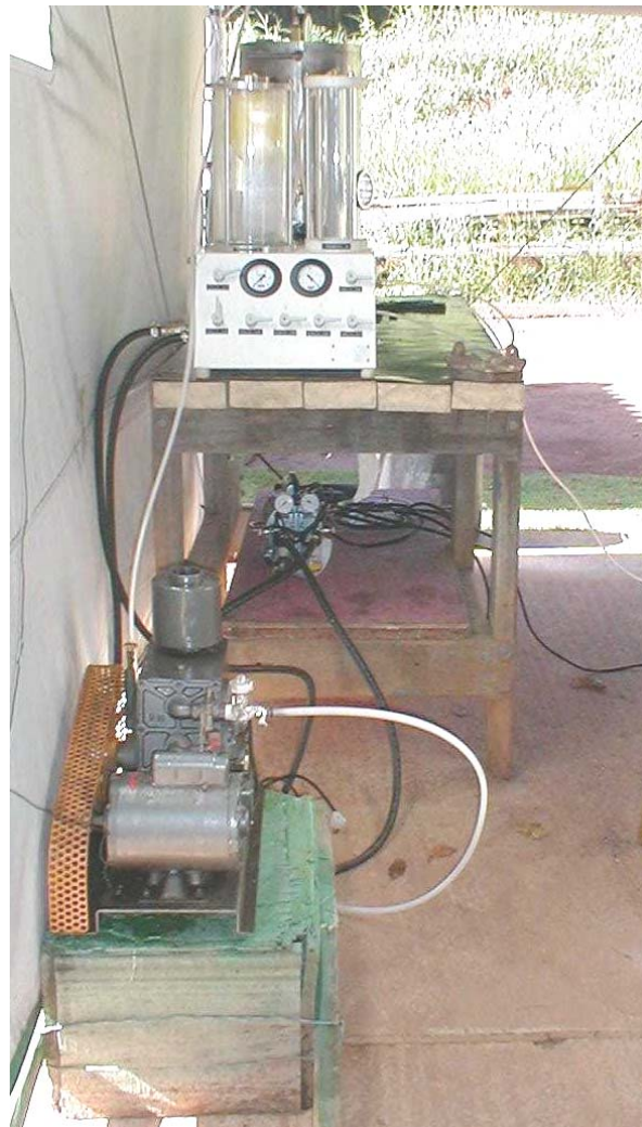
Figura 40 - Aparelho composto de bomba de pressão e vácuo e câmaras pressurizadas para circulação de água.
