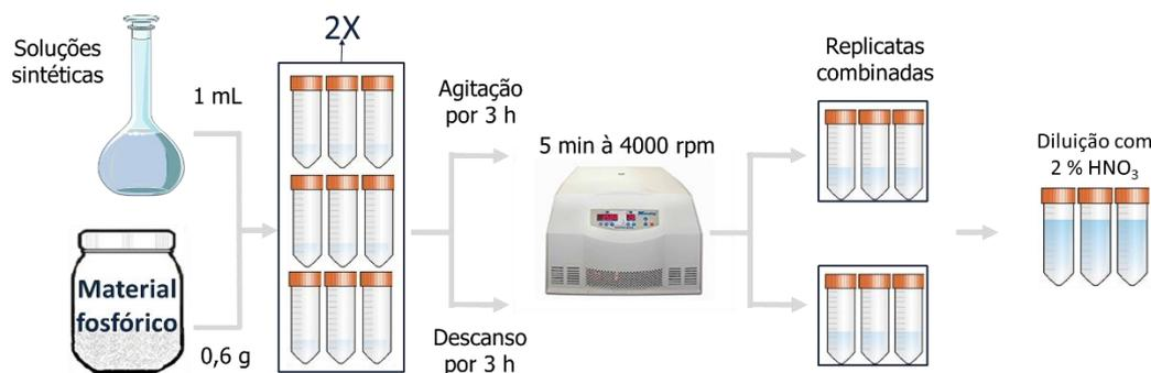
**Figura 6.** Esquema do procedimento empregado na lixiviação das amostras com soluções sintéticas.
