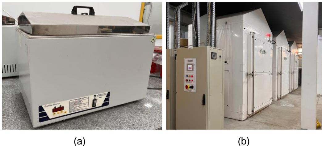
Figura 3-4. Equipamentos utilizados para o condicionamento das amostras submetidas ao envelhecimento higrotérmico controlado, condição: (a) CA-2; (b) CA-2.1.
