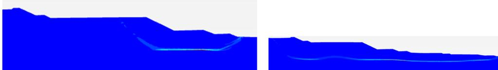
Figura 6.12 Deformações cisalhantes incrementais que definem a superfície de ruptura – Após berma de 1 m. Cenário com SSC à esquerda e MC (com  $S_u$ ) à direita.
