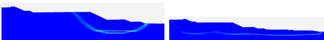
Figura 6.11 Deformações cisalhantes incrementais que definem a superfície de ruptura – após reforço em rachão. Cenário com SSC à esquerda e MC (com  $S_u$ ) à direita.
