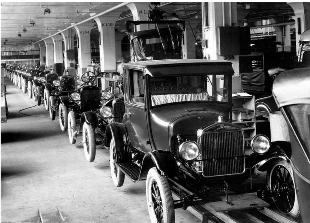
Figura 13 – Linha de montagem seriada para produção em massa, idealizada por Henry Ford.
