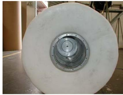
Figuras 71 e 72 - Visões traseira do pig com o vaso embutido.
