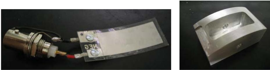
Figuras 42 e 43 – Membrana de PVDF e Suporte do Transdutor.
