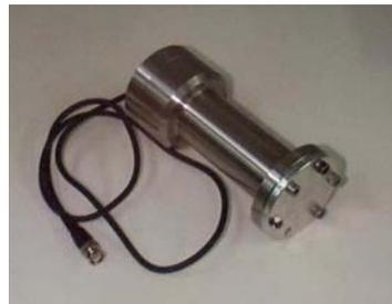
Figuras 27 e 28 – Desenho e foto do encapsulamento do sensor.
