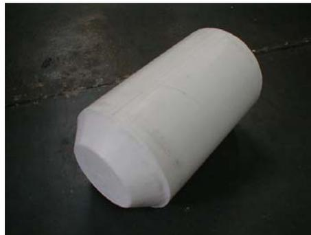
Figura 70– Pig espuma especial.
