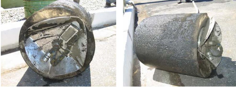
Figuras 82 e 83 – Parte traseira do pig, com os sensores e a eletrônica embarcada.
