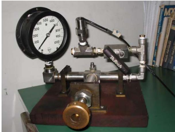
Figura 9 – Sistema hidráulico com pressão variável.
