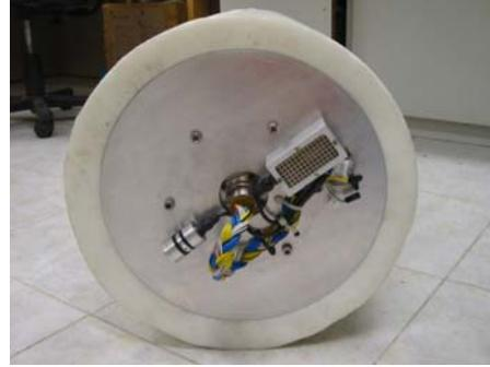
Figuras 74 e 75 – Visões do protótipo do Pig Acústico.
