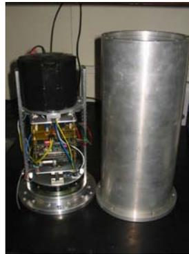
Figuras 73 – Vaso, eletrônica e bateria embarcados.
