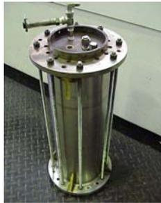
Figura 24 – Foto do vaso adaptado para operar com pressão interna de 1000 psi.
