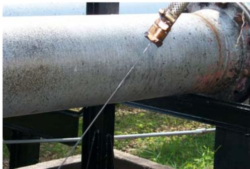
Figura 18 – Vazamento com furo de 1mm de diâmetro.
