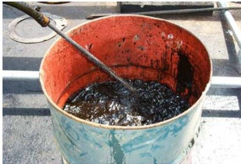
Figura 17 – Líquido sendo coletado para medição de vazão.
