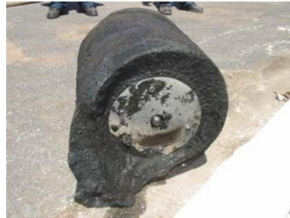
Figura 81 – Pig fragmentado em duas partes.
