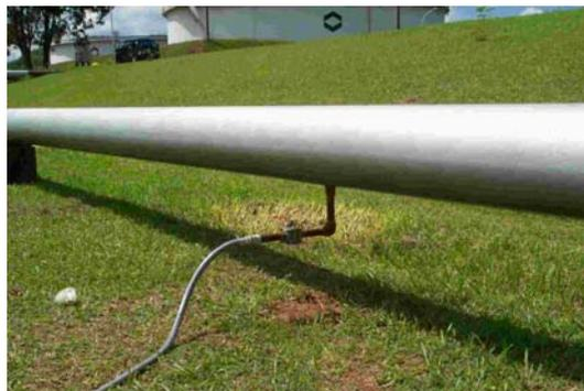
Figura 16 – Dreno instalado para simulação do vazamento.
