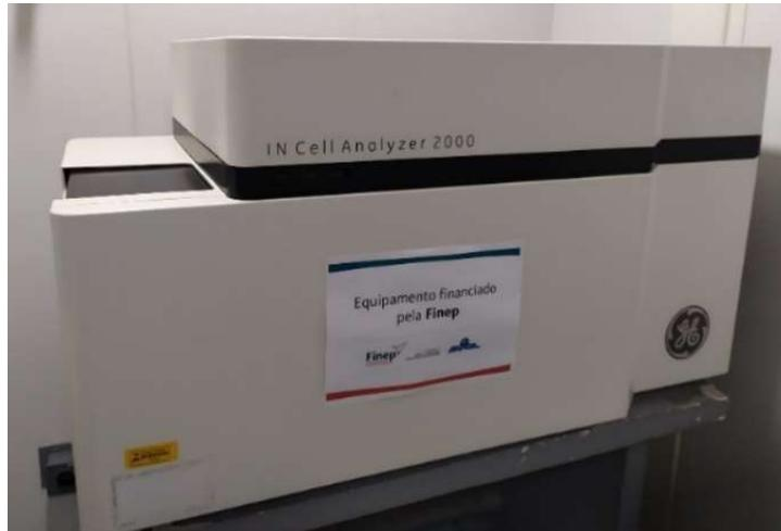
**Figura A.11:** Microscópio óptico de epifluorescência automatizado, InCell Analyzer 2000, localizado no Laboratório de Biotecnologia (LABIO) do Instituto Nacional de Metrologia, Qualidade e Tecnologia (INMETRO).
