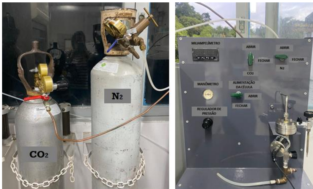
Figura 3.12: Bancada do sistema de testes de permeação de gases e cilindros dos determinados gases.
