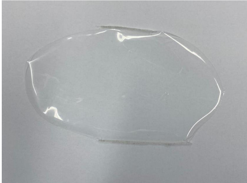
Figura 3.8: Membrana sintetizada de matriz mista de poliuretano com líquido iônico incorporado.
