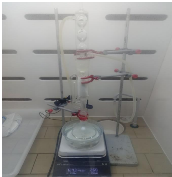
Figura 4.4. Sistema de extração Soxhlet usado para a limpeza da rocha
