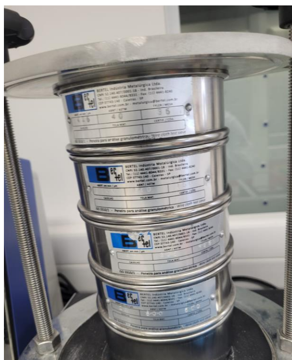
Figura 4.3. Disposição das peneiras na etapa de peneiramento
