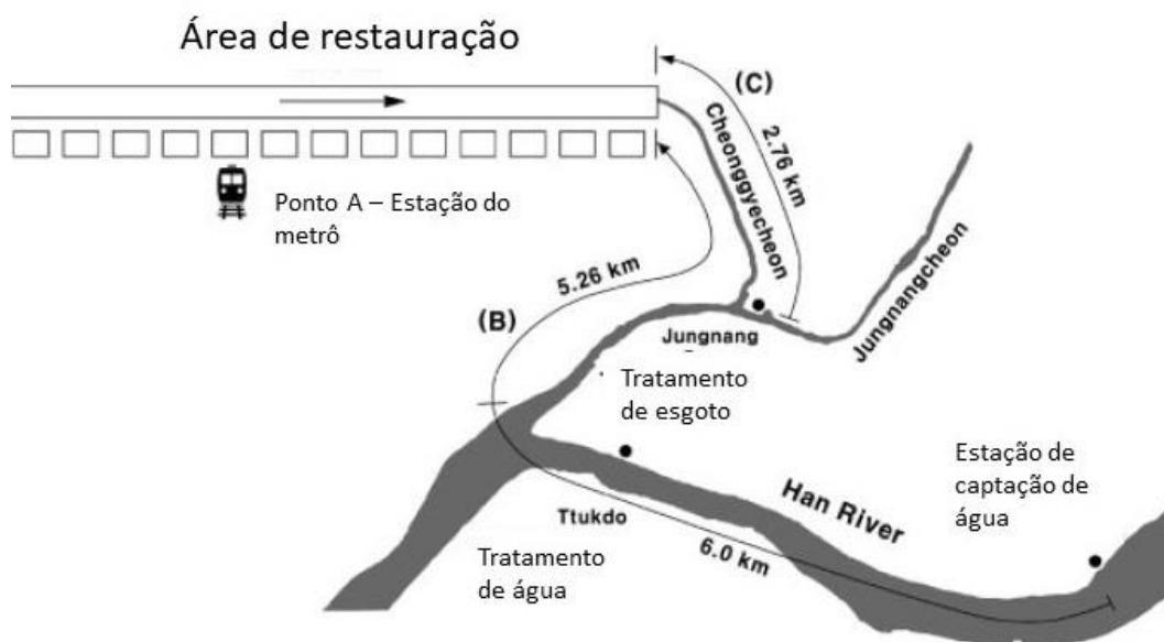
Figura 36 - Pontos de desvios para a criação de manutenção do fluxo de águas do Cheonggyecheon. Fonte: Jeon & Kang (2019), tradução nossa.
