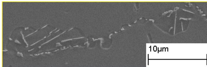
Figura 4.06 – Micrografia eletrônica de varredura (ES) de uma amostra recozida a 1050<sup>o</sup>C por 90 min e envelhecida a 900<sup>o</sup>C por 1h. Evidência de mecanismo de crescimento em 'S' das colônias de precipitação descontínua.
