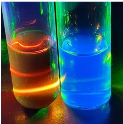
Figura 14 – Dispersão de CDs sob excitação UV 365 nm (CDs partir de o-aminofenol em etanol e ácido cítrico em água)
