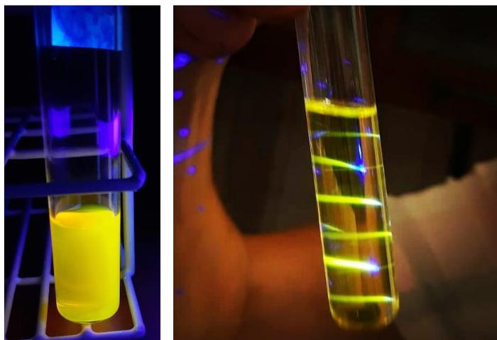
Figura 16 - Dispersão de CDs sob excitação UV 365 nm em etanol
