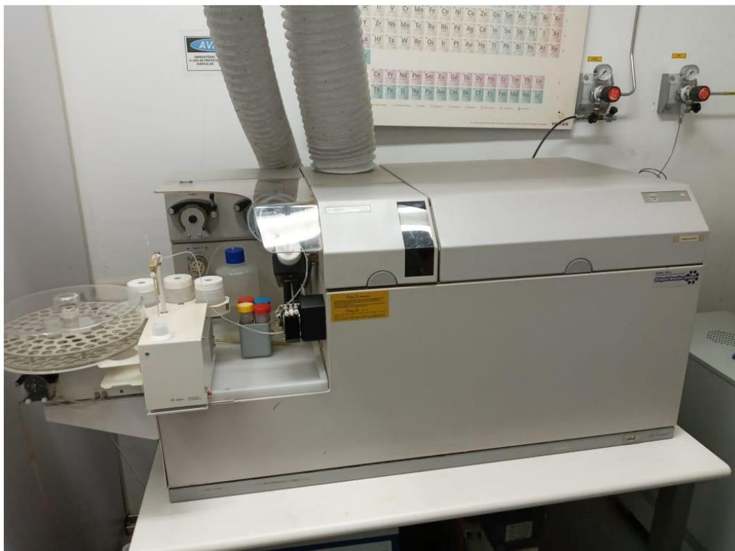
Figura 6: Espectrômetro de massas com plasma indutivamente acoplado Agilent 7500 ce. Fonte: Próprio autor
