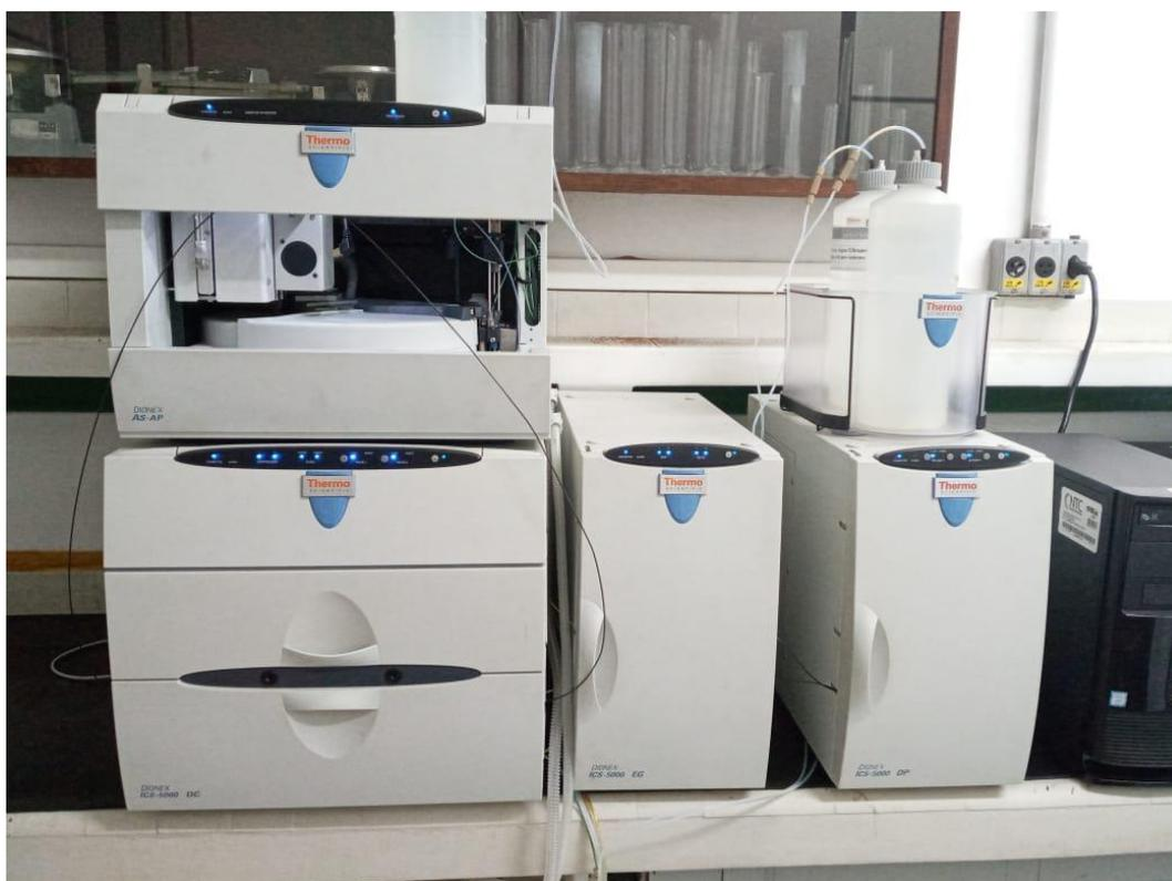
Figura 5: Cromatógrafo de íons Dionex ICS 5000. Fonte: Próprio autor
