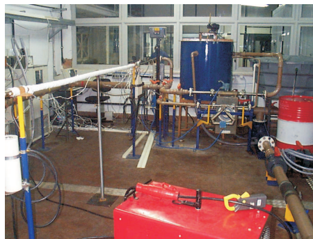
Figura 5.2: Circuito hidráulico e seus equipamentos
