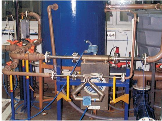
Figura 4.4: Medidores de vazão
