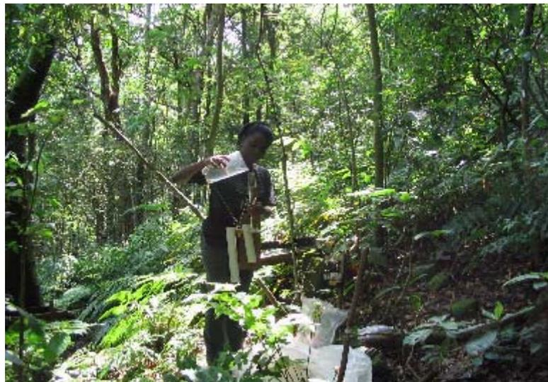
Figura 7- Fotografia mostrando um ponto de coleta das amostras de água de chuva que atravessam o dossel (área fechada).
