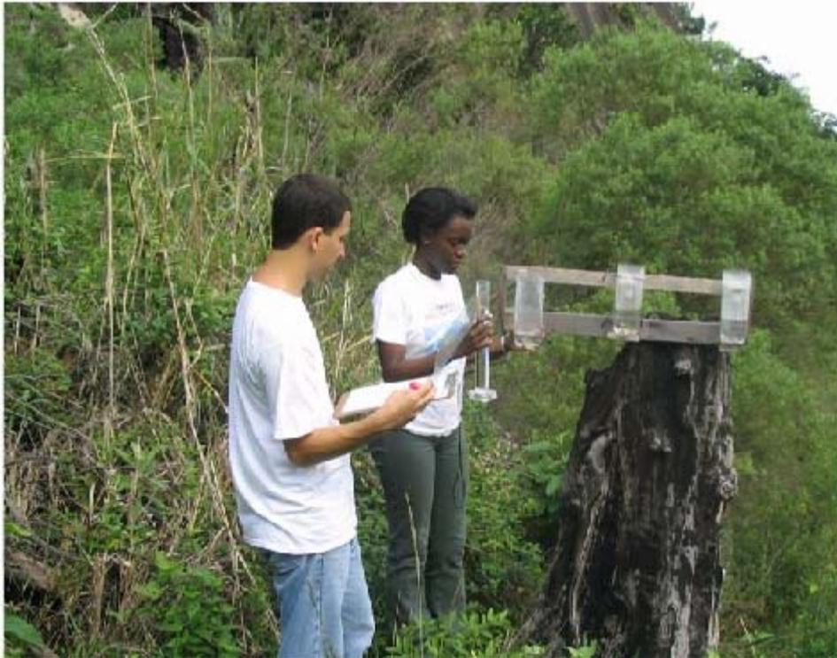
Figura 6- Fotografia mostrando um ponto de coleta das amostras de água de chuva incidente sobre área aberta.
