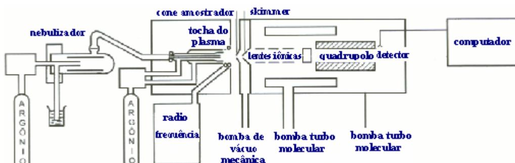
Figura 11- Diagrama de blocos do aparelho Elan 6000 , Perkin – Elmer Sciex.
