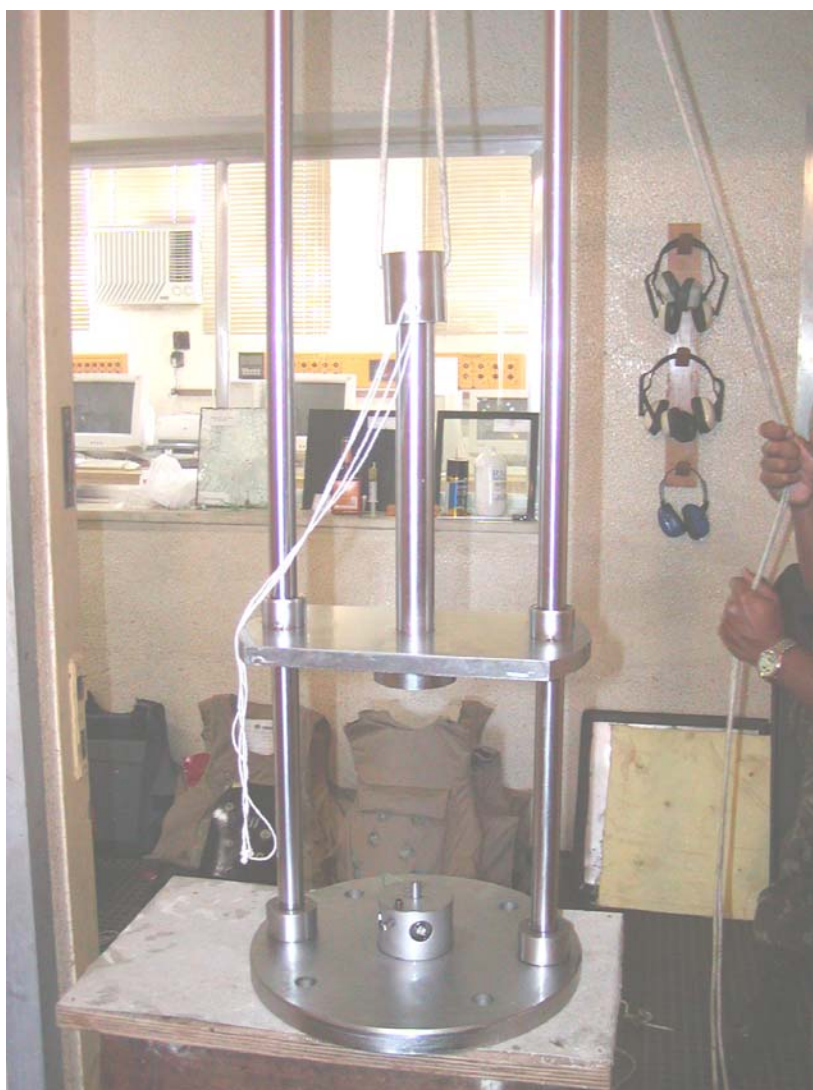
Figura 74 – Calibrador Dinâmico de Piezelétrico, em fase de testes no Campo de Provas da Marambaia (CPrM) do Exército
