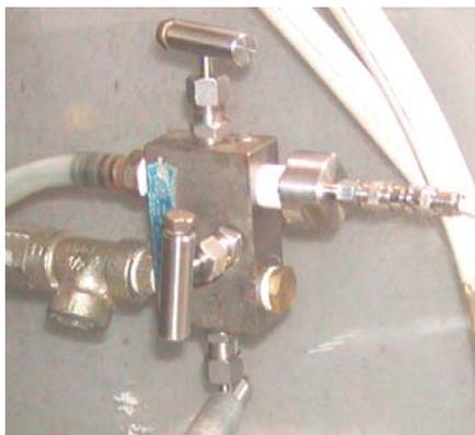
Figura 10 – Câmara de teste, com as válvulas e com o transdutor piezelétrico de pressão
