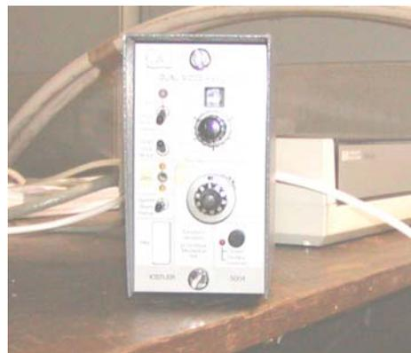
Figura 11 - Amplificador de Carga, Kistler, modelo 5004
