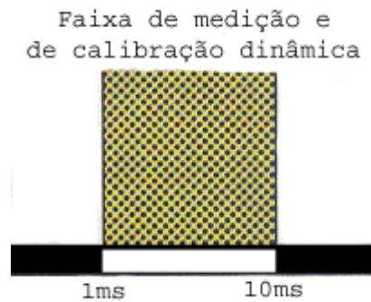
Figura 7 – Faixa de medição e de calibração dinâmica. Fonte: Catálogo do fabricante AVL: “Piezoelectric High Pressure Transducers”
